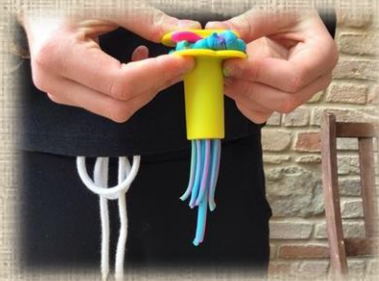
Estrusione attraverso la filiera
